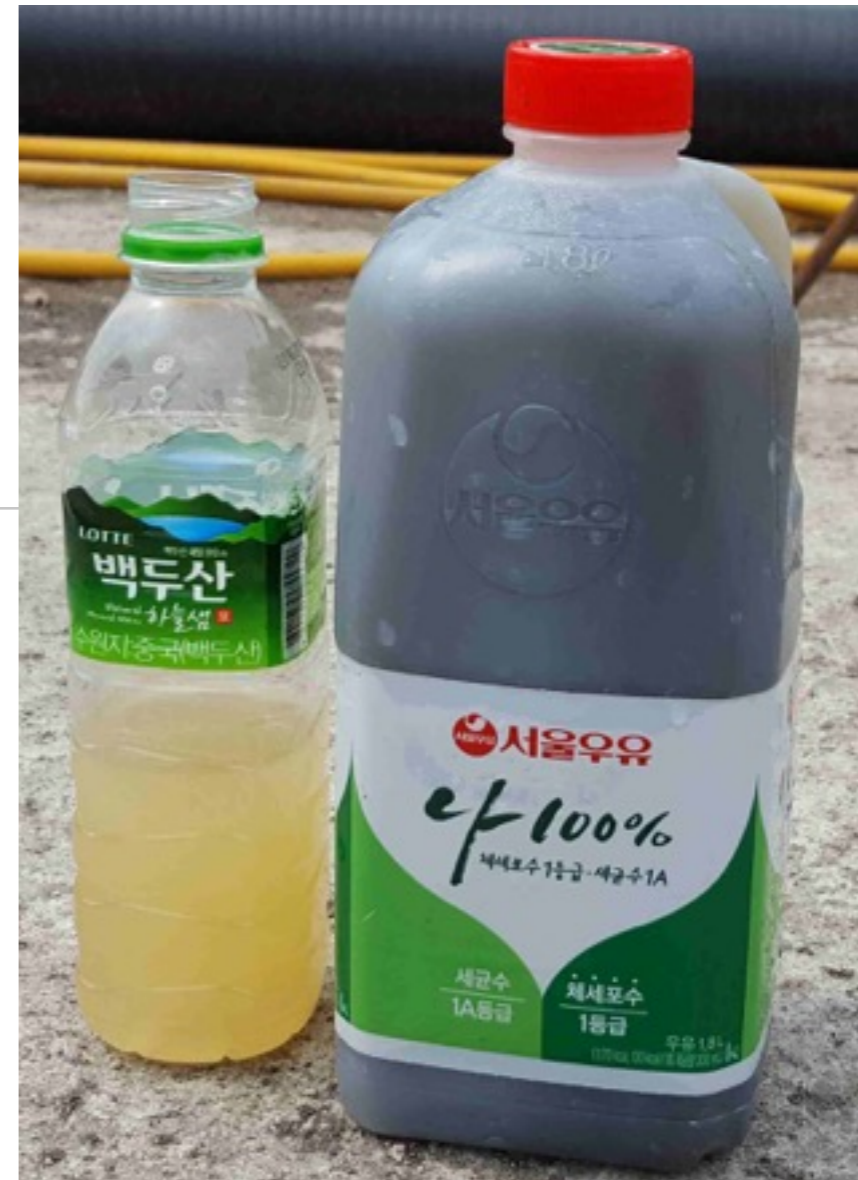
Рідина з могильника до (зправа) та після (зліва) обробки озоном
